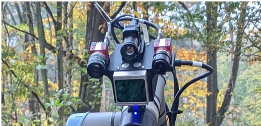
Figuur 2. Voorbeeld van een multi-spectrale (RGB, SWIR, LWIR) camera en LiDAR systeem voor objectdetectie
